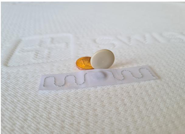
Die RFID Hochfrequenz Transponder in den Hotelmatratzen von Swissfeel lassen sich demnächst mit Hilfe eines Smartphones auslesen / Foto: Swissfeel
