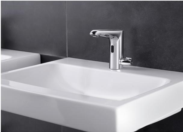
Elektronische Armaturen wie diese Xeris E-T mit Thermostat von Schell gewährleisten den Verbrühungsschutz am Waschtisch, erkennen eigenständig eine Nutzungsunterbrechung und reagieren darauf mit einer Stagnationsspülung / Foto: Schell
